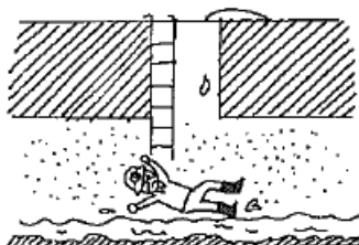
マンホール内に硫化水素滞留
