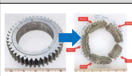
破断したハイスピード・ピニオンギア
