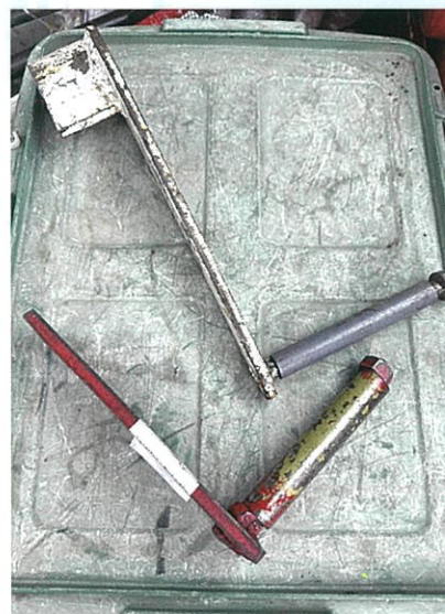
水門の開閉に使用するハンドル (職員の手作りです)
