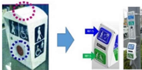
「音響式信号機」と「青延長用押ボタン 付き信号機」の機能を持つ信号機の タッチ式スイッチ
