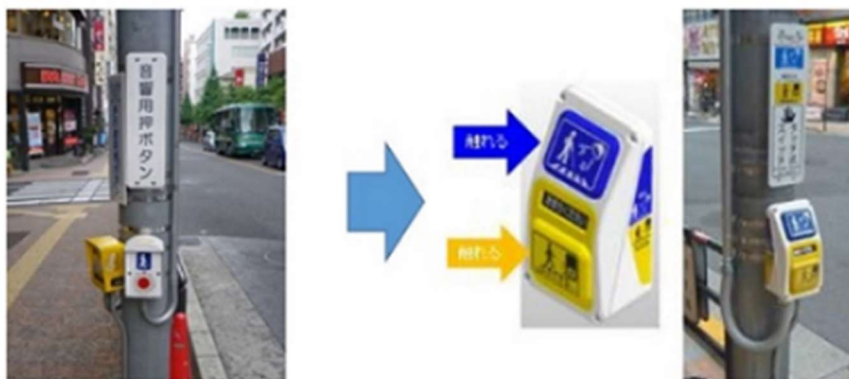
「音響式信号機」と「歩行者用押ボタン」 の機能を持つ信号機の タッチ式スイッチ
