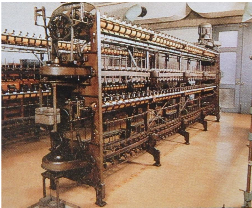
「イタリア式撚糸機」の拡大写真
