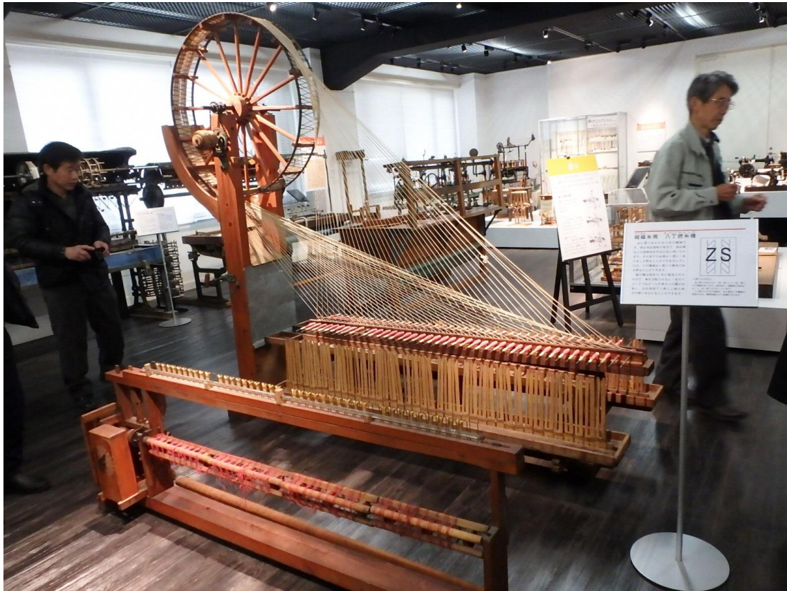
写真 1：縮緬糸用 八丁撚糸機（昭和 41 年製）
