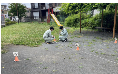
●観測地点の土壌を採取しダイオキシン類の測定をします
