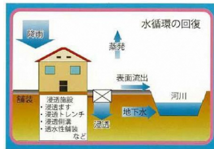
図 3-9 浸透施設の設置効果
