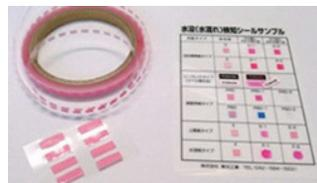
▲独自開発の紙とインクで誤検知が極めて少ないのが特徴の水没検知シール
