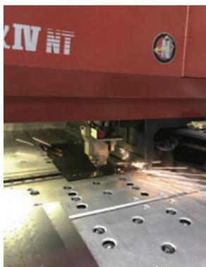
▲レーザーで材料を切断
