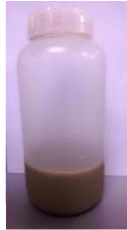
基礎杭工事で使用されたベントナイト
