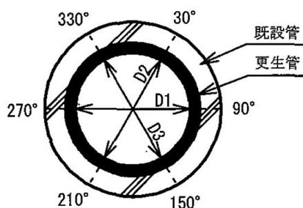
図 7 仕上り内径の測定位置
