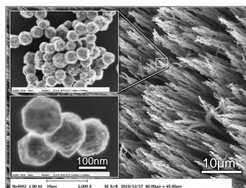
図2 高結晶性 Ni ナノ粒子のナノトラス構造
