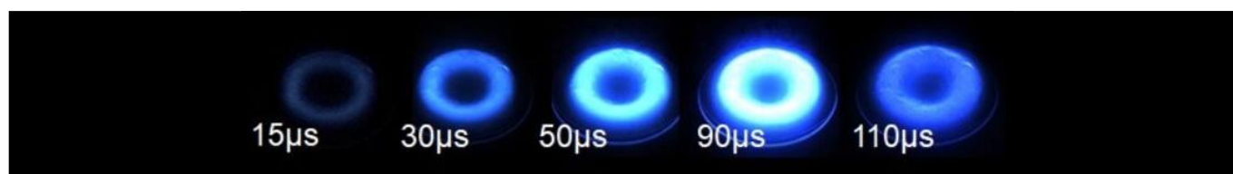
図1 高速度カメラにより撮像した大電力パルススパッタにおけるパルス放電の時間推移
