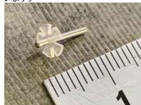
図3 フィルム積層バイオ分析用構造体
