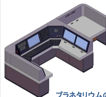
モールドと板金を 組合せた機器設計
