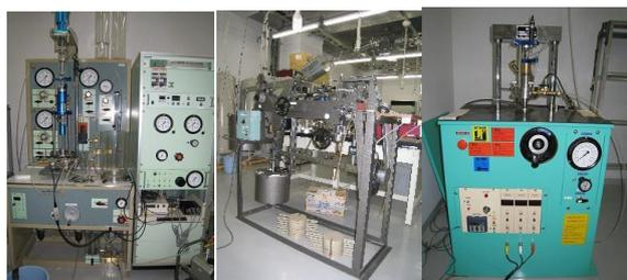
動的三軸圧縮試験機/一面せん断試験機/定ひずみ圧密試験機
