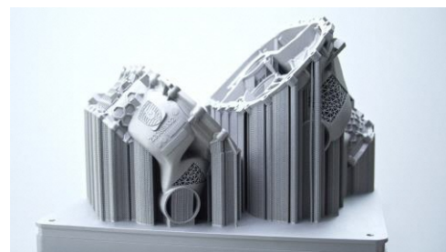
図1 ポルシェは電動ドライブのハウジングを3Dプリンタで作製
