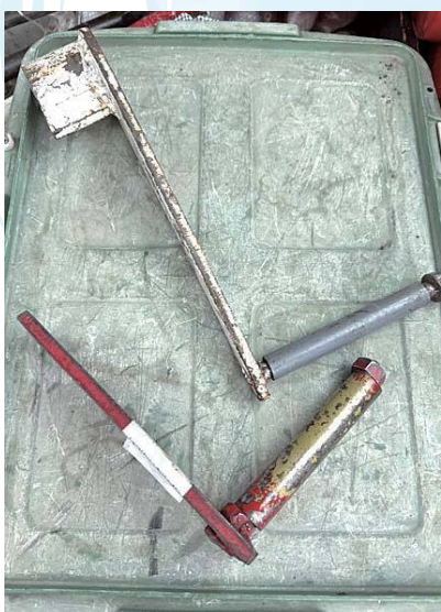
水門の開閉に使用するハンドル（職員の手作りです）
