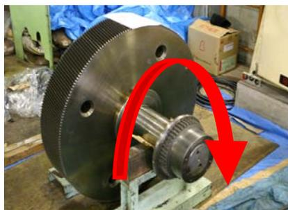
タービンの回転速度を発電機の回転速度（1秒間に25回転）に合わせる装置です。
