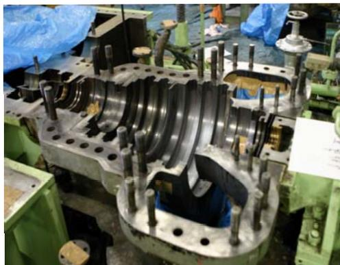
この車室の中に、右上の車軸（ロータ）が組み込まれます。
