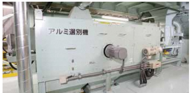
⑫ アルミ選別機 うず電流により破碎物の中からアルミ類を取り出すものです。
