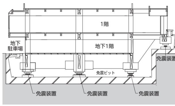
▲建物基礎の下を掘削し免震装置を取り付け
