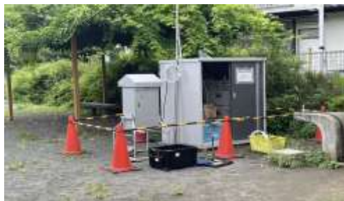
●観測地点に大気質測定機材を設置します
