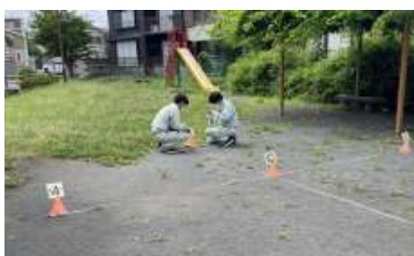
●観測地点の土壌を採取しダイオキシン類の測定をします
